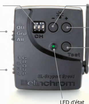
Fig. 2 Sélecteur d'une des 8 fréquences radio (choix d'un canal)
